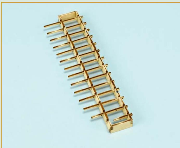
**16** Аккуратно, чтобы не повредить эти мелкие детали, извлеките из заготовки нервюры руля G1–G14, а затем последовательно вставьте их в пазы стапеля, как показано на снимке.
