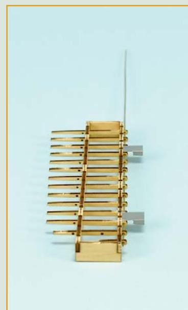
**19** Возьмите один из латунных стержней, полученных в этой посылке, и аккуратно проденьте его в отверстия всех нервюр и шарниров, как показано на снимке.
